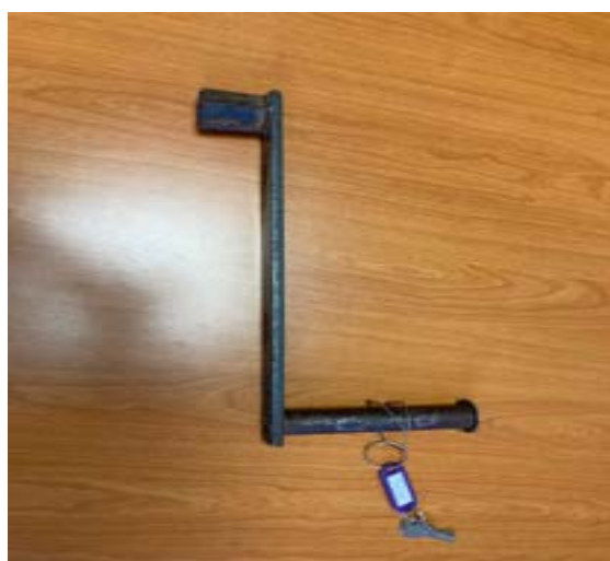
Photo 2 : Manivelle des vannes + clé des cadenas
